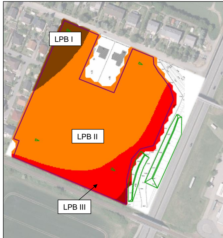
Lärmpegelbereiche maßgeblicher Außenlärmpegel: Nachtwerte
