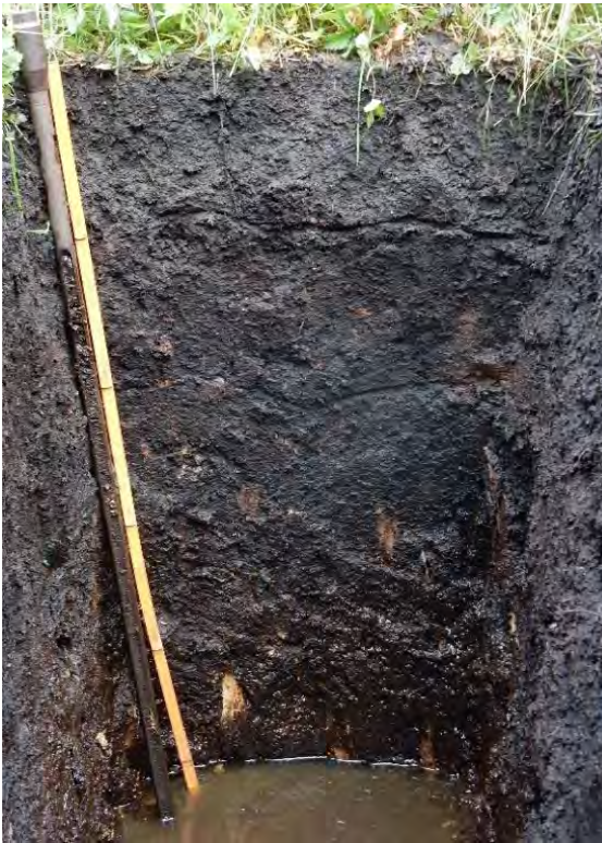
Abbildung 13: Niedermoorboden, Feinseggen- über Erlenbruchtorf, Wiesenweg/Schwerin (QUELLE: UNTERE BODENSCHUTZBEHÖRDE LH SCHWERIN 2020).
