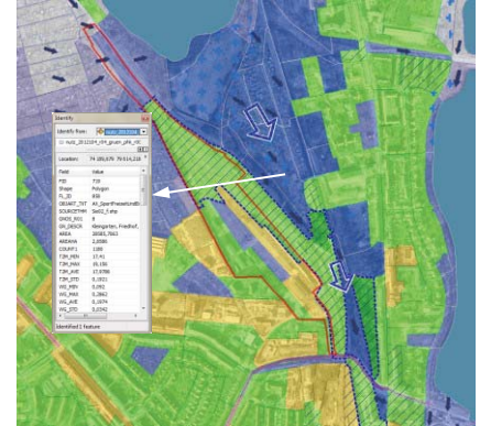
Aus den Sachdaten lassen sich die Flächenstatistik und der Grund für die Einstufungen entnehmen:
